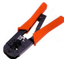
Рис. 22.10. Инструмент для обжима витой пары
