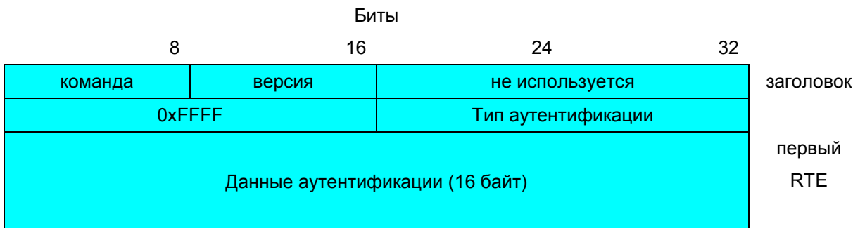
Начальная часть пакета RIPv2 при использовании аутентификации
