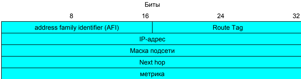
Формат поля RTE для RIPv2
