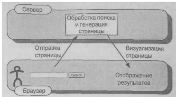
Рис. 12.1. Классическая модель поиска с обозначенными этапами обработки
