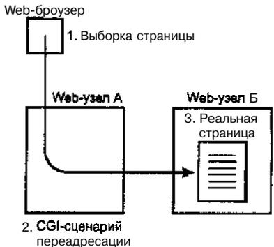
Рис. 20.4. Схема процесса перенаправления запроса с одного Web-узла на другой
