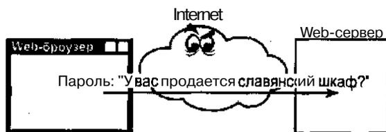
Рис. 18.6. Обычный текст пересылается на сервер
